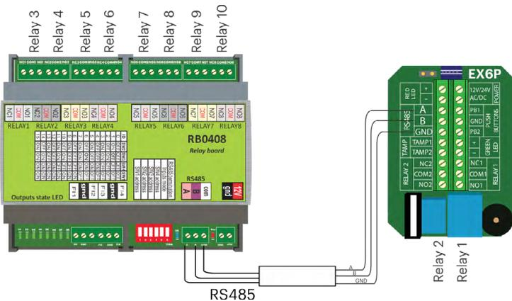
L'EX6 en connexion avec le RB0408 est idéal pour des petites installations nécessitant plus de 2 relais. Les 2 relais du EX6 + les 8 relais du RB0408 lui donne la possibilité de pouvoir gérer jusqu'à 10 relais au total.
